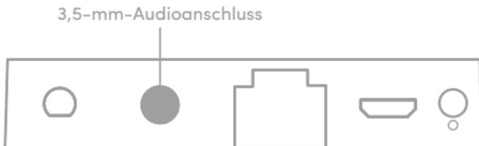
Schließen Sie einen beliebigen Lautsprecher über den 3,5-mm-Audioanschluss an den Flic Hub an.
